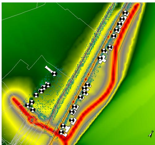
Figure 30 : logiciel CADNAA : exemple d'une carte d'isophones indiquant la propagation sonore d'un projet de déviation d'une infrastructure routière
