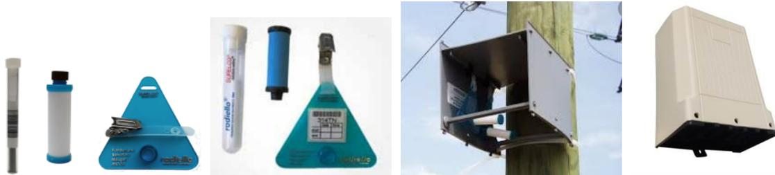
Figure 1 : Matériel utilisé pour les prélèvements d'air ambiant et la mesure des particules fines. De gauche à droite : Capteur passif Radiello Code 130 (Tube en verre avec charbon actif, corps diffusif et support triangulaire), Radiello Code 166 (Tube en plastique avec support en polyéthylène microporeux imprégné de triéthanolamine), abri extérieur Radiello, sonde QAA de Nanosense.
