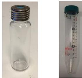
Figure 2 : Matériel utilisé pour les prélèvements des eaux de ruissellement. De gauche à droite : Flacon en verre et flacon en polypropylène.
