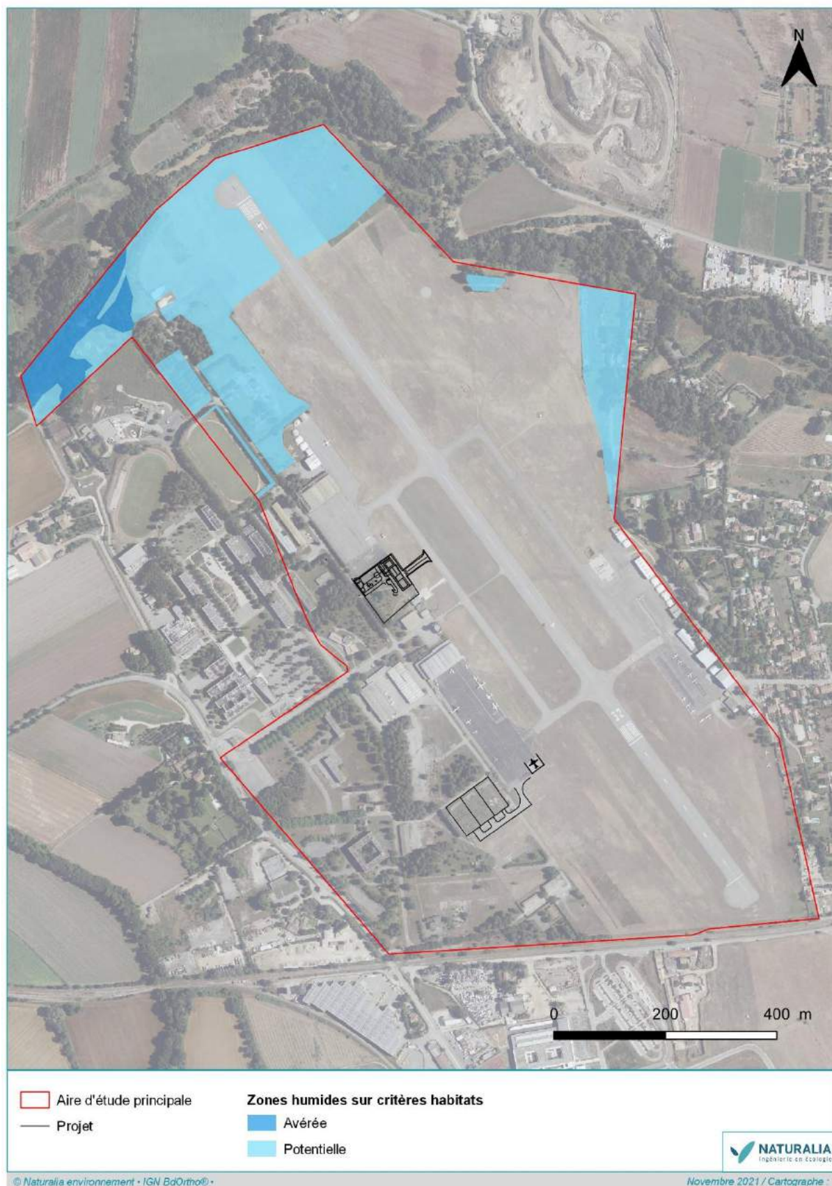
Figure 13. Bilan de la localisation des zones humides avérées et potentielles identifiées sur critère habitats et suite aux sondages pédologiques sur l'emprise de la zone projet
