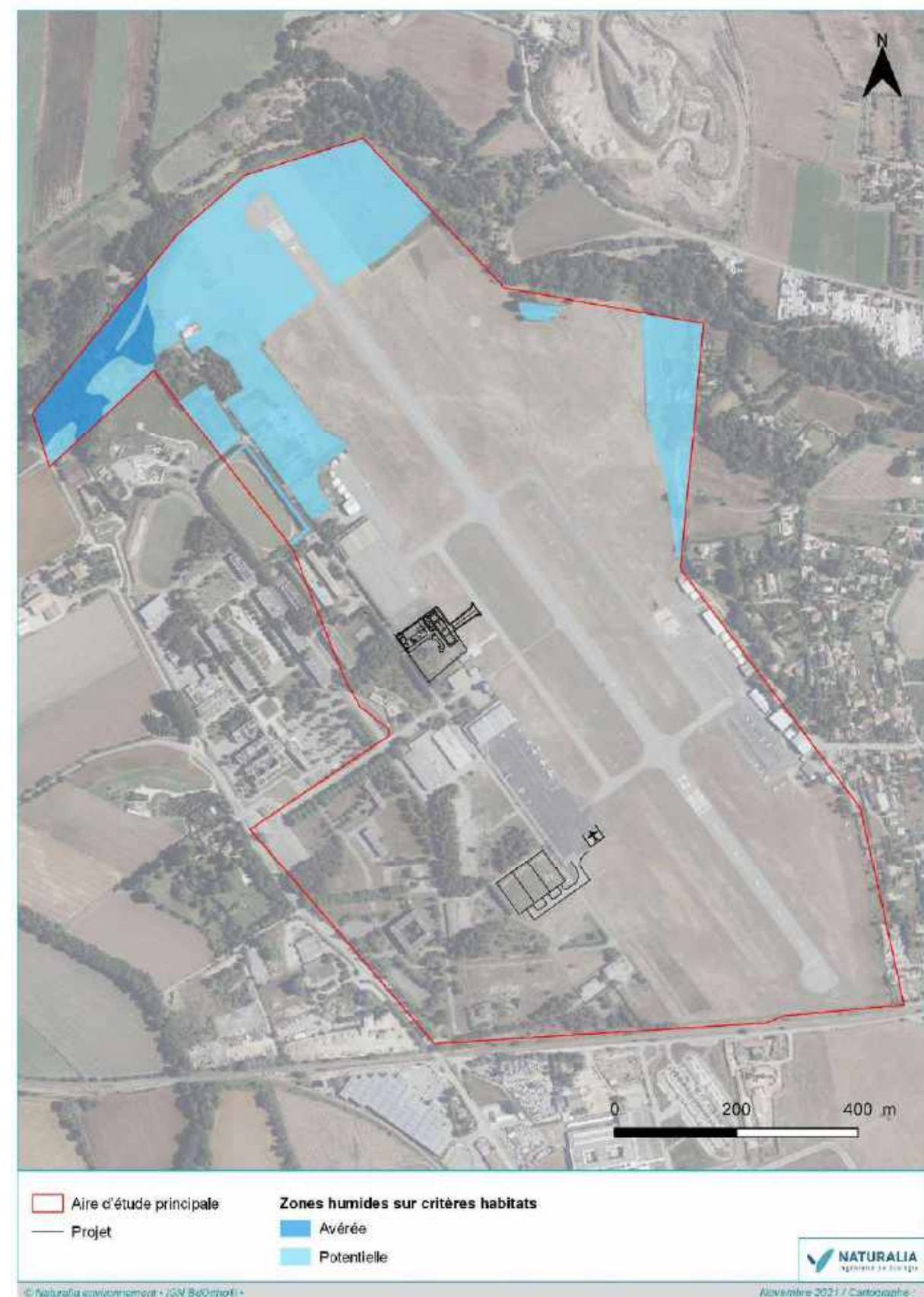
Figure 52. Bilan de la localisation des zones humides avérées et potentielles identifiées sur critère habitats et suite aux sondages pédologiques sur l'emprise de la zone projet
