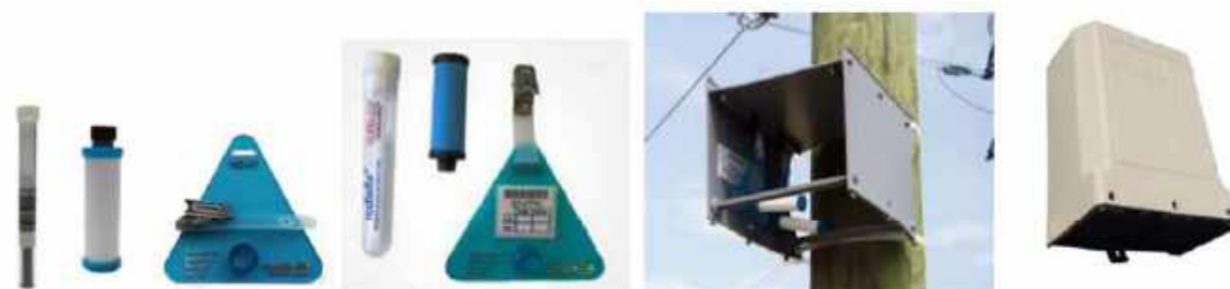
Figure 1 : Matériel utilisé pour les prélèvements d'air ambiant et la mesure des particules fines. De gauche à droite : Capteur passif Radiello Code 130 (Tube en verre avec charbon actif, corps diffusif et support triangulaire), Radiello Code 166 (Tube en plastique avec support en polyéthylène microporeux imprégné de triéthanolamine), abri extérieur Radiello, sonde QAA de Nanosense.
