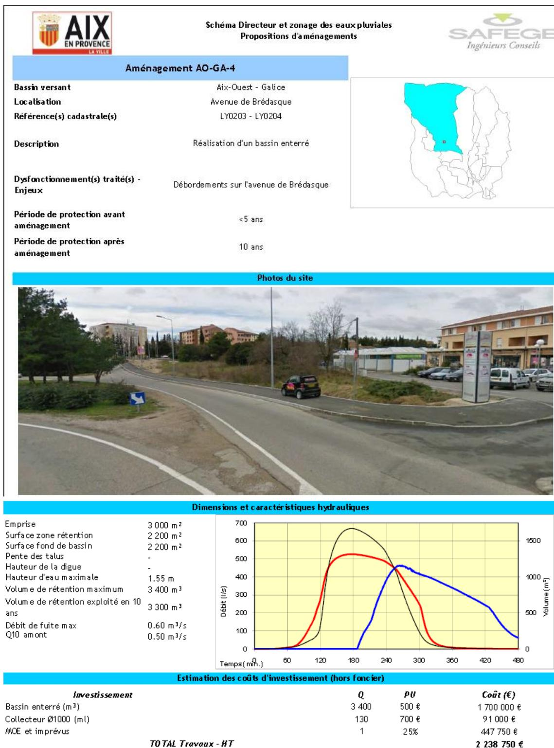
Figure 5: Ouvrage AO-GA-4 (extrait du Schéma Directeur Eau pluviale Safege 2015)
