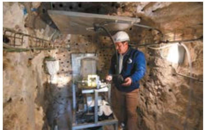
**A L'INTÉRIEUR, UN PENDULE AVEC UN FIL DE PLOMB, TRAVERSANT TOUTE LA HAUTEUR DU BARRAGE, PERMET DE SURVEILLER EN PERMANENCE LA STABILITÉ DE L'ÉDIFICE EN MESURANT TOUS SES MOUVEMENTS.**
