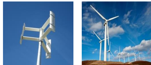
Eoliennes à axe vertical et horizontal
