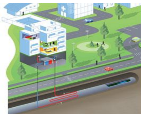
Principe de récupération de chaleur sur les eaux usées (degré
