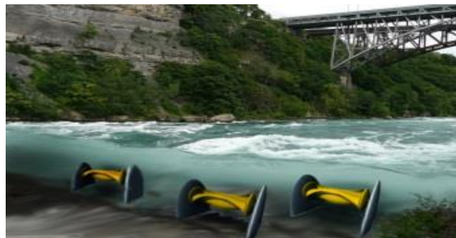
Hydroliennes implantées dans un fleuve
