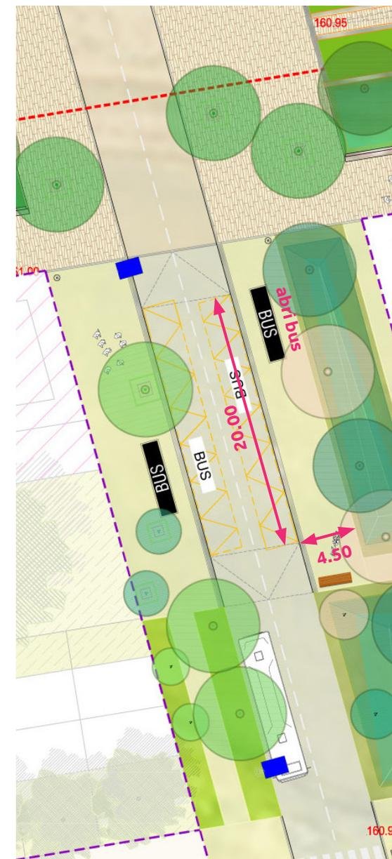
Principe d'implantation d'une station bus (Cours du Pilon du Roy)
