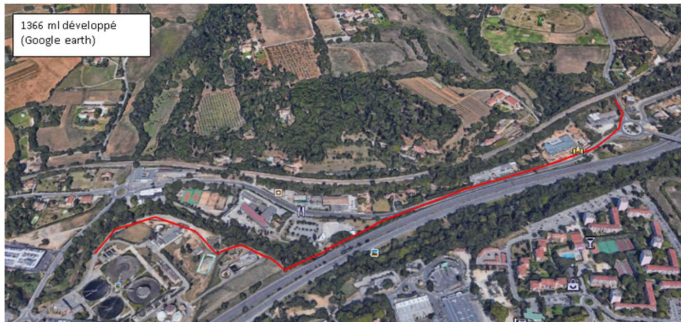
SCHEMA N° 4 : PROPOSITION DE TRAJET DE LA BOUCLE D'EAU TEMPÉRÉE ENTRE LA STEP ET LA ZAC
